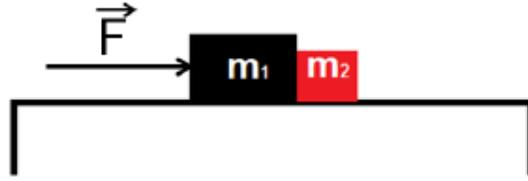
**Abbildung 2:** Eine Kraft wirkt auf den ersten Block, der den anderen Block mit anderer Masse schiebt.
