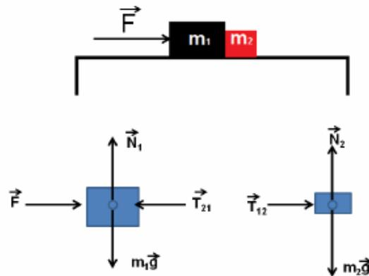
**Abbildung 3:** Eine Kraft wirkt auf den ersten Block, welcher einen anderen Block mit anderer Masse anschiebt.
