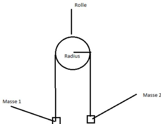
Abbildung 1: Atwoodsche Maschine (Quelle:www.physikerboard.de)
